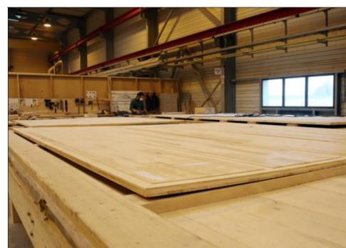
L'usine transforme environ 15 000 m<sup>3</sup> de hêtre par an dans un processus automatisé en flux continu. Au final, le pont d'usinage permet de découper à façon les panneaux avec leurs portes, fenêtres, passages de gaines, etc.
